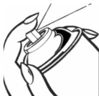
Appliquer les couches de laque conformément aux instructions du fabricant de laque. Lors d'un séchage accéléré la température maximum autorisée ne doit pas excéder 70°.
