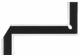
Alupanel peut être facilement plier manuellement après fraisage préliminaire au verso avec rainure en V en utilisant une scie à panneaux.
