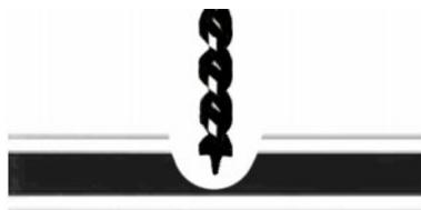
Alupanel peut être percé avec les mêmes machines et les mêmes forets hélicoïdaux que l'on utilise pour l'aluminium et les matières plastiques.
